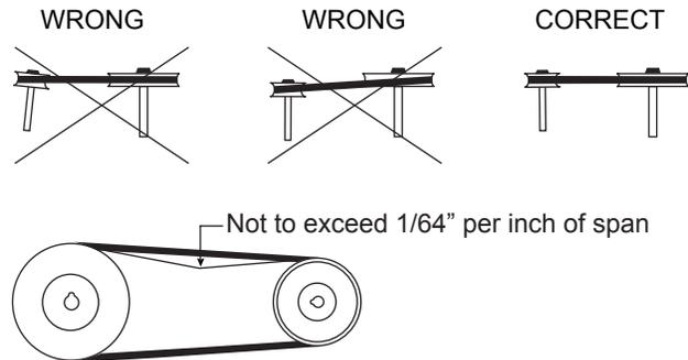
FIGURE 1: PULLEY ALIGNMENT
